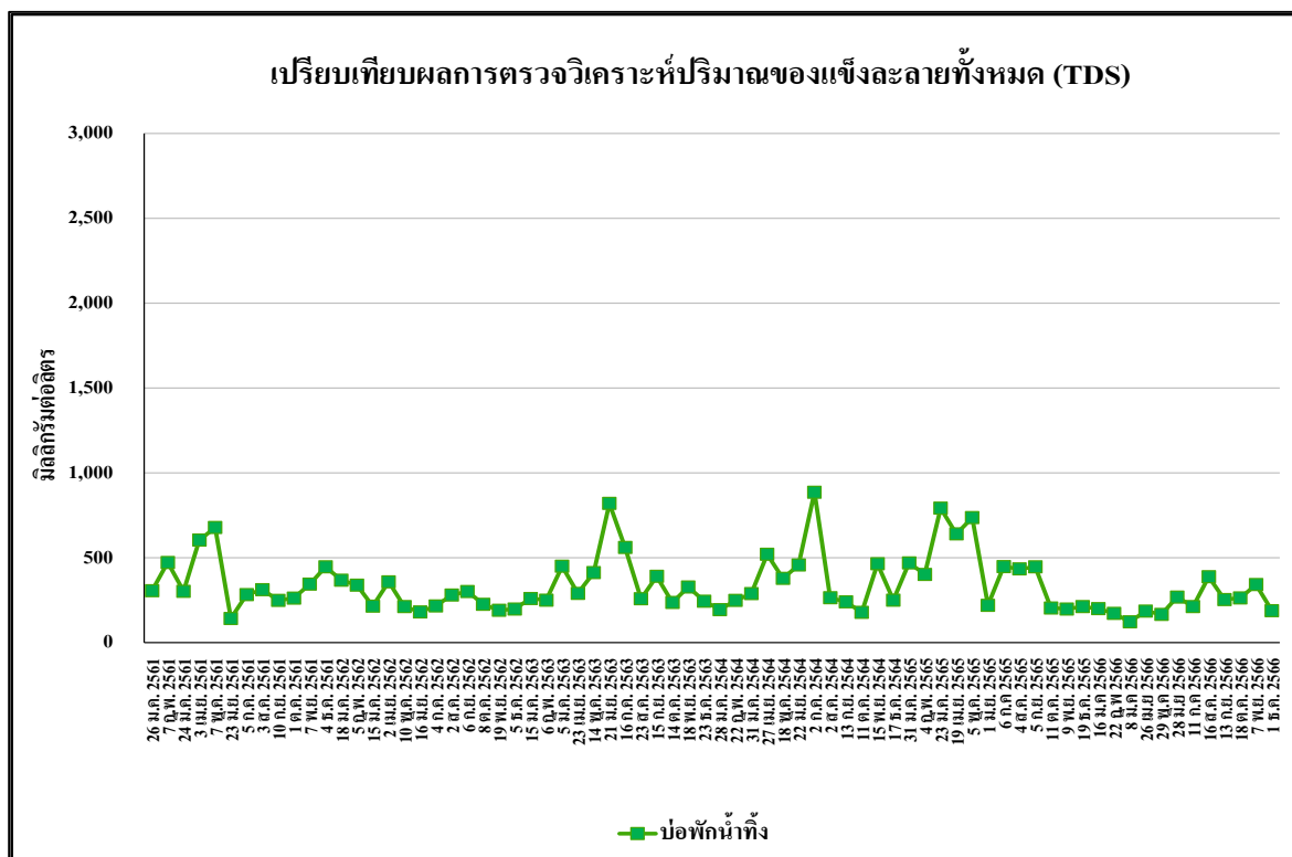
รูปที่ 5.4.2-5 เปรียบเทียบผลการตรวจวิเคราะห์ปริมาณของแข็งละลายทั้งหมด (TDS) ของบ่อพักน้ำทิ้ง ระหว่างเดือนเดือนมกราคม 2561 – ธันวาคม 2566
