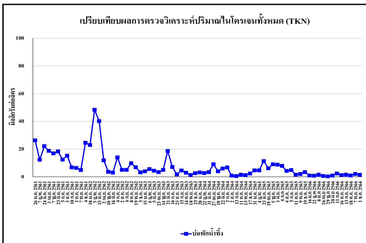
รูปที่ 5.4.2-10 เปรียบเทียบผลการตรวจวิเคราะห์ปริมาณไนโตรเจนทั้งหมด (TKN) ของบ่อพักน้ำทิ้ง ระหว่างเดือนมกราคม 2561 – ธันวาคม 2566
