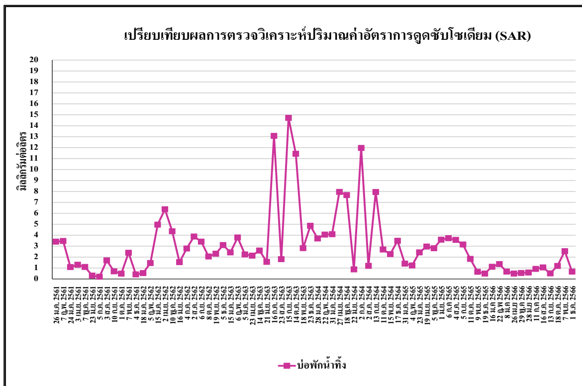
รูปที่ 5.4.2-16 เปรียบเทียบผลการตรวจวิเคราะห์ค่าอัตราส่วนการดูดซับโซเดียม (SAR) ของบ่อพักน้ำทิ้ง ระหว่างเดือนมกราคม 2561 – ธันวาคม 2566
