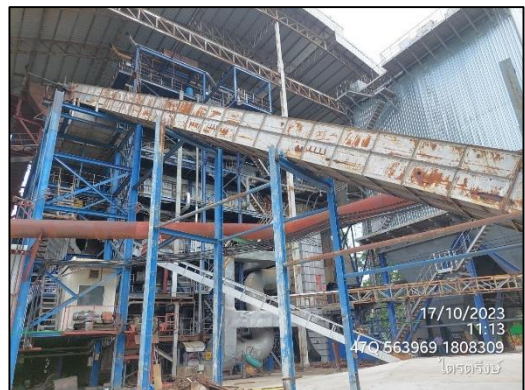
ภาพที่ 23 ระบบสายพานลำเลียงเข้าแบบระบบปิด
