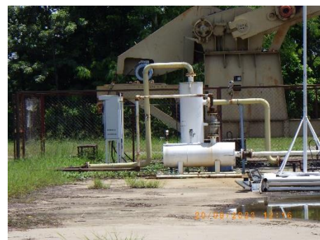
รูปที่ 2-3 อุปกรณ์แยกของเหลว-ก๊าซ (Separator) และ Knock Out Drum
