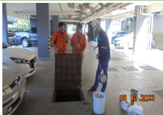
รูปที่ 3-6 คุณภาพน้ำทิ้งก่อนการบำบัด บริเวณท่อปรับสภาพของระบบบำบัดน้ำเสียอาคาร C
