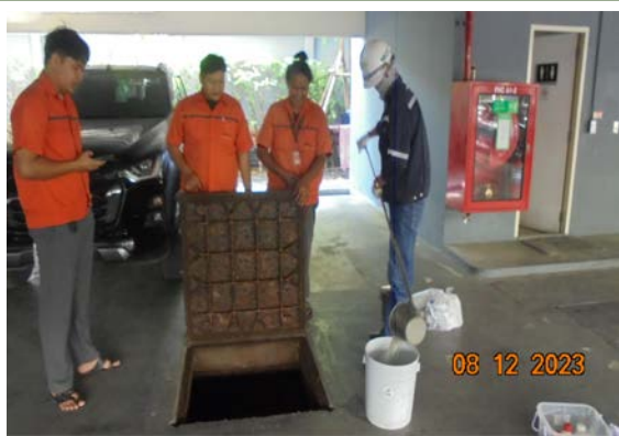
รูปที่ 3-2 คุณภาพน้ำทิ้งก่อนการบำบัด บริเวณท่อปรับสภาพของระบบบำบัดน้ำเสียอาคาร A
