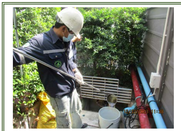
รูปที่ 3-5 การเก็บตัวอย่างคุณภาพน้ำทิ้ง บริเวณบ่อพักน้ำสุดท้ายก่อนระบายออกสู่ท่อ ระบายน้ำสาธารณะ
