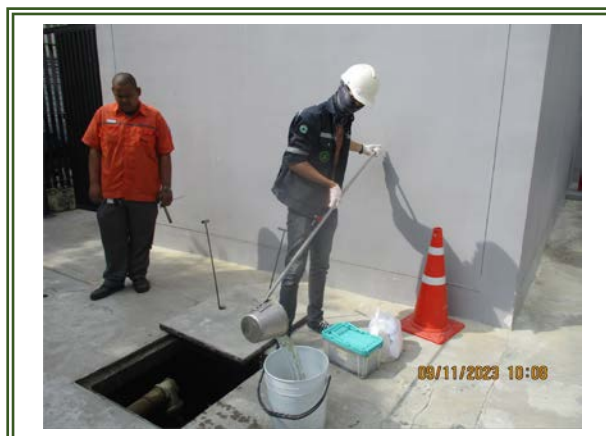
รูปที่ 3-5 การเก็บตัวอย่างคุณภาพน้ำทิ้ง บริเวณบ่อสูบน้ำทิ้งก่อนระบายออกนอกโครงการ
