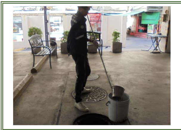
รูปที่ 3-4 การเก็บตัวอย่างคุณภาพน้ำทิ้ง บริเวณจุดเก็บน้ำก่อนผ่านระบบบำบัด ถึงที่ 2
