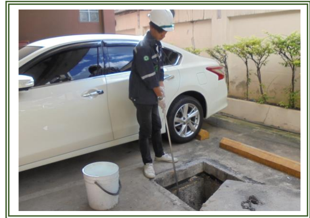
รูปที่ 3-5 การเก็บตัวอย่างคุณภาพน้ำทิ้ง บริเวณจุดเก็บน้ำหลังผ่านระบบบำบัด ถึงที่ 2
