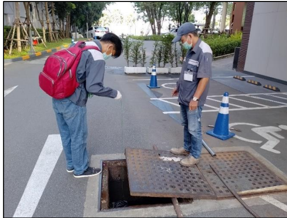
รูปที่ 3.1 การเก็บตัวอย่างคุณภาพน้ำทิ้ง บริเวณจุดปล่อยน้ำเสียก่อนเข้าระบบบำบัดน้ำเสีย
