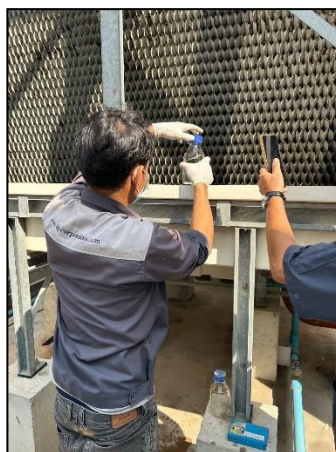
รูปที่ 3.7 การเก็บตัวอย่างเชื้อลี้จิโอเนลลาจากท่อน้ำทิ้งของระบบปรับอากาศ
