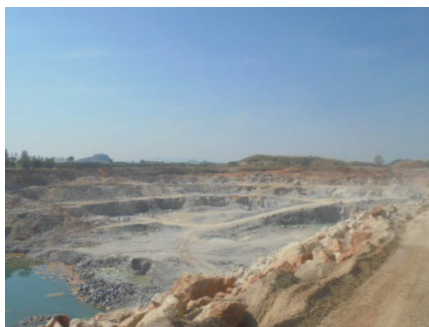
รูปที่ 2-38: การทำเหมืองแบบชั้นบันได
