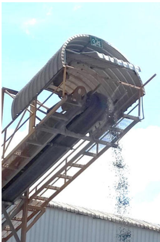
มีการสเปรย์น้ำบริเวณปลายสายพานเพื่อลดฝุ่นละออง
