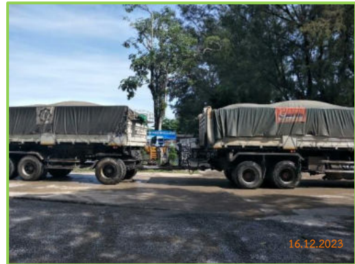
ภาพที่ 2-9 การปิดคลุมกระบะบรรทุกแร่ก่อนออกจากโรงโม่หิน
