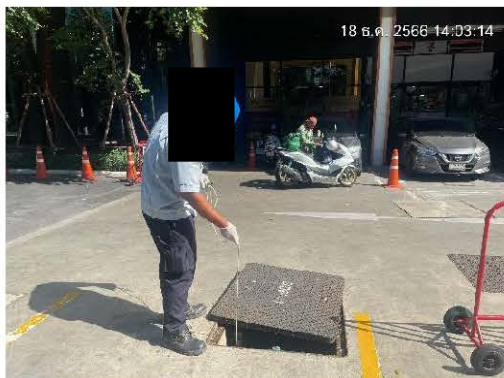
การเก็บตัวอย่างน้ำบ่อพักน้ำสุดท้ายก่อนระบาย
