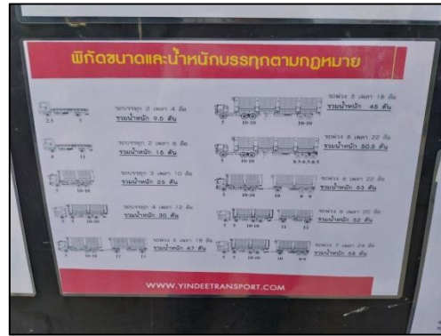
รูปที่ 48 ป้ายควบคุมน้ำหนักบรรทุกรถ
