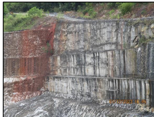
ภาพที่ 2.22 เปิดหน้าเหมืองแบบขั้นบันได
