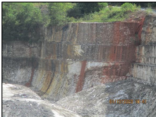
ภาพที่ 2.22 เปิดหน้าเหมืองแบบขั้นบันได
