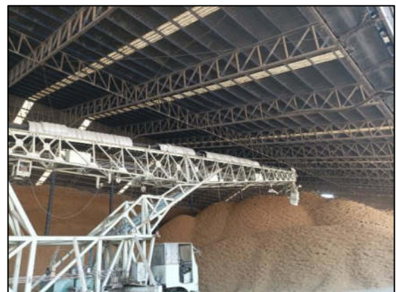
รูปที่ 15 การติดตั้งท่อยืด (Bellow) บริเวณส่วนปลายของสายพานลำเลียง
