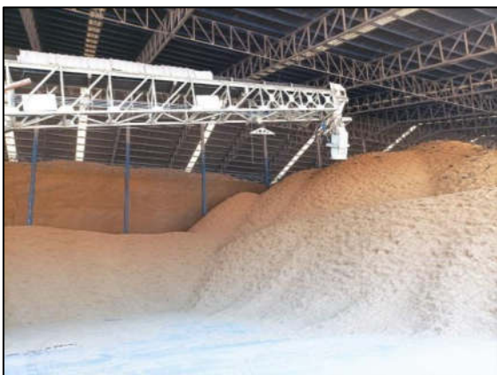
รูปที่ 15 การติดตั้งท่อยืด (Bellow) บริเวณส่วนปลายของสายพานลำเลียง
