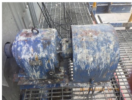
Picture 87 : CE rapping motor
