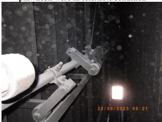
Picture 63 : Intact DE anvil
