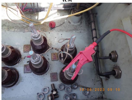
Picture 81 : HV - O1 phase insulation test
