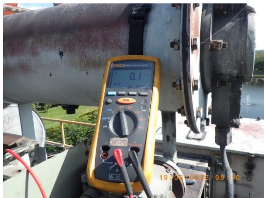
Picture 79 : HV - +VE (+) phase insulation test
