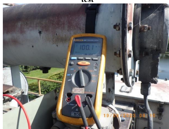
Picture 82 : HV - O1 phase insulation test
