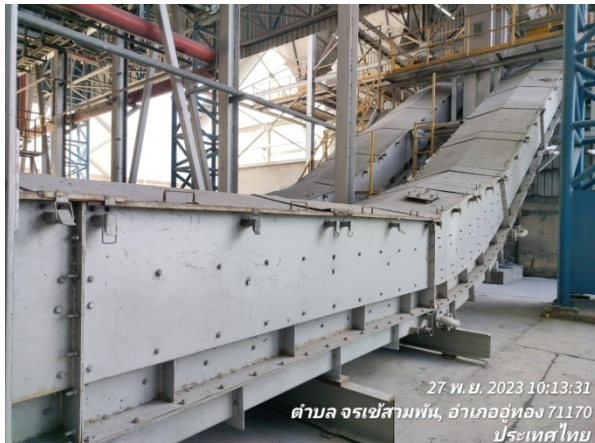
รูปที่ 2-27 ระบบลำเลียงเถ้าจากห้องเผาไหม้หม้อไอน้ำมีการปิดครอบมิดชิด
