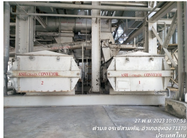
รูปที่ 2-27 ระบบลำเลียงเถ้าจากห้องเผาไหม้หม้อไอน้ำมีการปิดครอบมิดชิด
