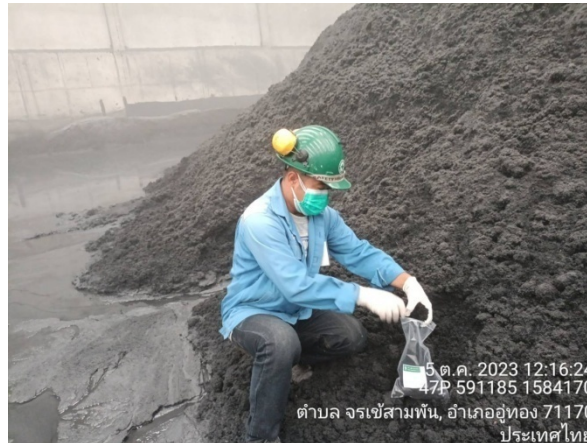
รูปที่ 3.8-2 แสดงการเก็บตัวอย่างคุณสมบัติของถ่าน (เก็บตัวอย่างเมื่อวันที่ 5 ตุลาคม 2566)
