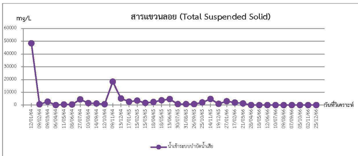
ภาพที่ 3.5.4-2 กราฟเปรียบเทียบผลการตรวจวิเคราะห์คุณภาพน้ำทั้งก่อนเข้าระบบบำบัดน้ำเสีย ระหว่างปี พ.ศ. 2564 ถึง ปัจจุบัน
