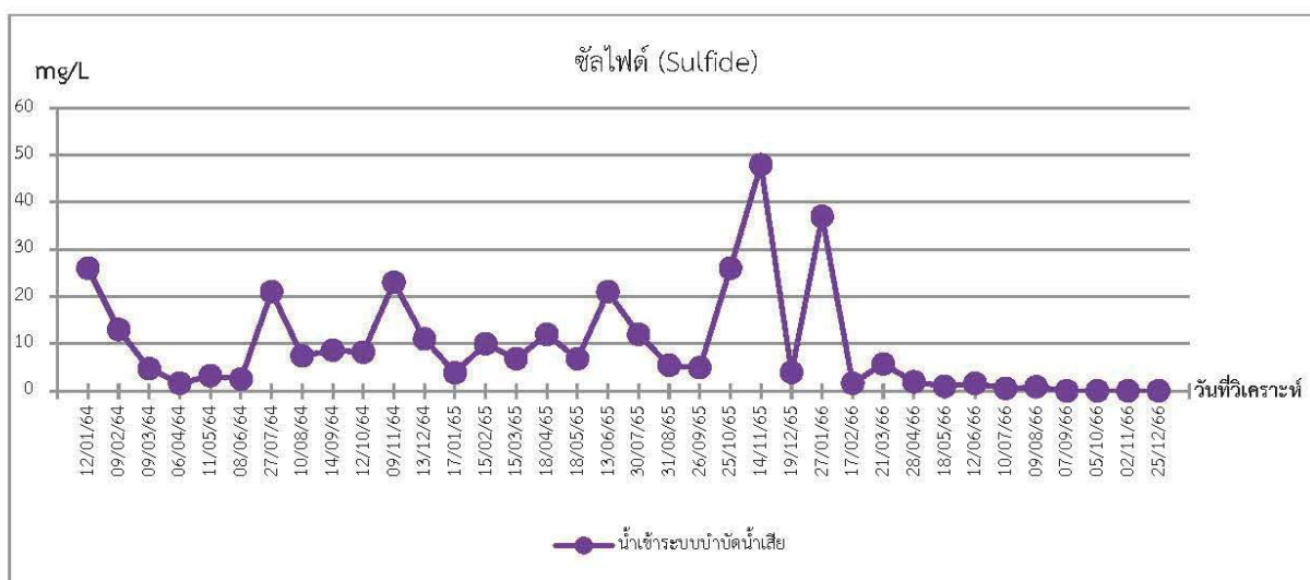
ภาพที่ 3.5.4-2 (ต่อ) กราฟเปรียบเทียบผลการตรวจวิเคราะห์คุณภาพน้ำทั้งก่อนเข้าระบบบำบัดน้ำเสีย ระหว่างปี พ.ศ. 2564 ถึง ปัจจุบัน
