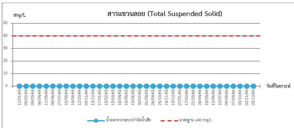
ภาพที่ 3.5.4-3 กราฟเปรียบเทียบผลการตรวจวิเคราะห์คุณภาพน้ำที่ออกจากระบบบำบัดน้ำเสีย ระหว่างปี พ.ศ. 2564 ถึง ปัจจุบัน
