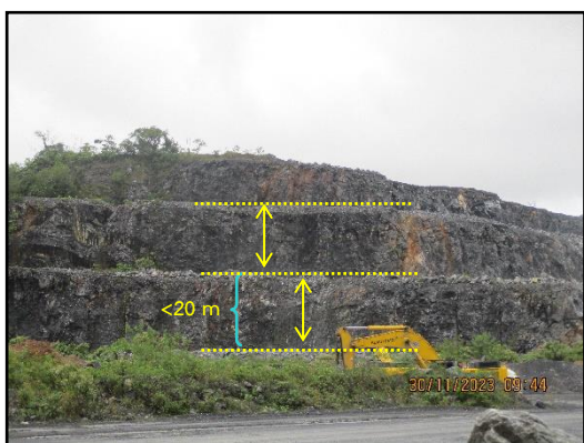
ภาพที่ 1.7 การออกแบบหน้าเหมืองทำเป็นลักษณะขั้นบันได
