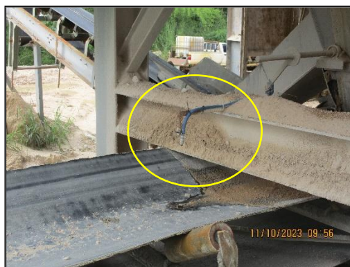
ภาพที่ 2.15 การติดตั้งระบบสเปรย์น้ำบริเวณจุดกำเนิดฝุ่น
