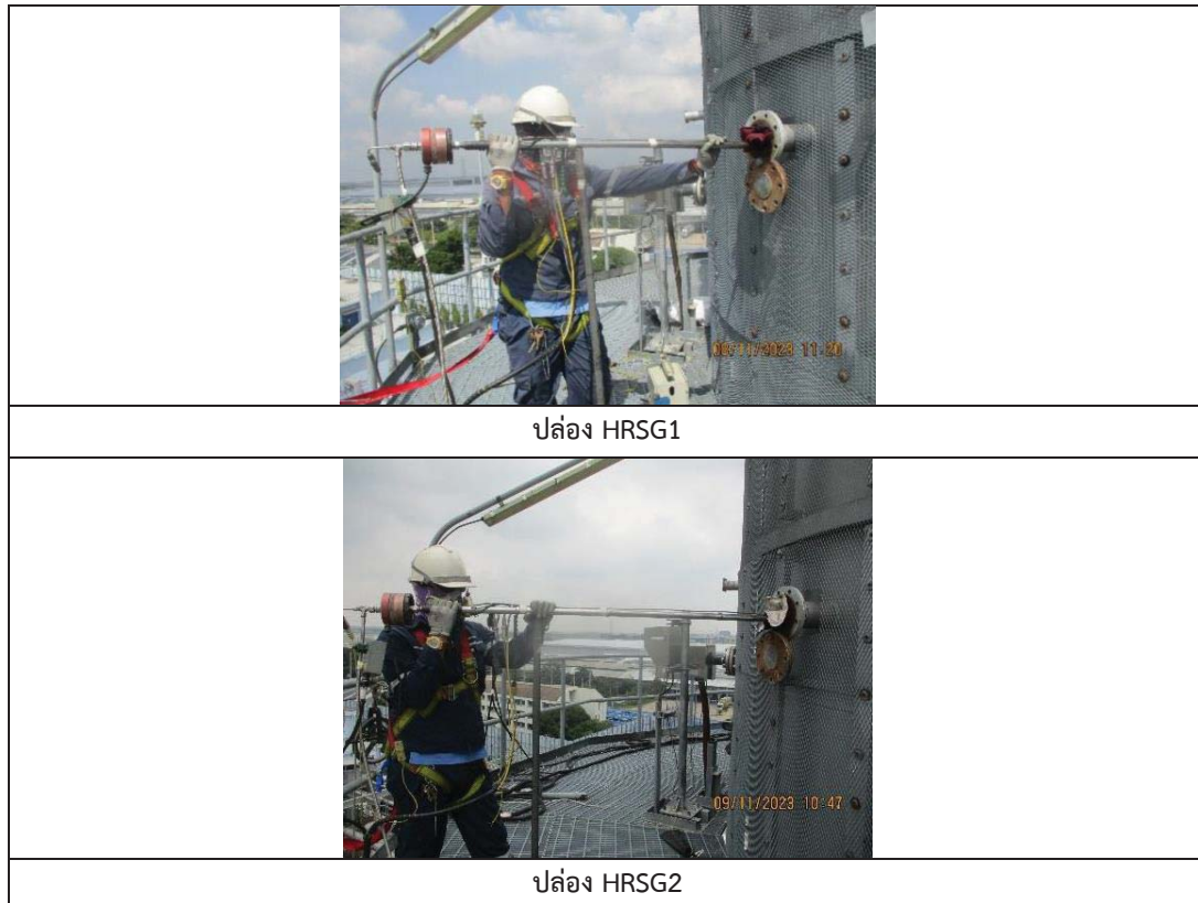
ภาพที่ 3.2-2 : การเก็บตัวอย่างอากาศจากปล่องระบาย HRSG1 และปล่อง HRSG2 ของโครงการ เมื่อวันที่ 8-9 พฤศจิกายน 2566
