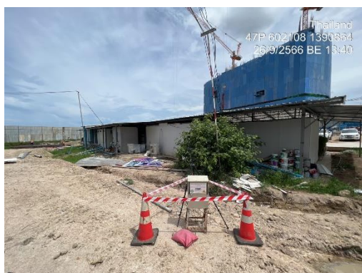
รูปที่ 17 ติดตั้งเครื่องตรวจวัดคุณภาพสิ่งแวดล้อม (คุณภาพอากาศ ระดับเสียง และความสั่นสะเทือน)
