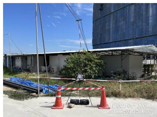
รูปที่ 17 ติดตั้งเครื่องตรวจวัดคุณภาพสิ่งแวดล้อม (คุณภาพอากาศ ระดับเสียง และความสั่นสะเทือน)
