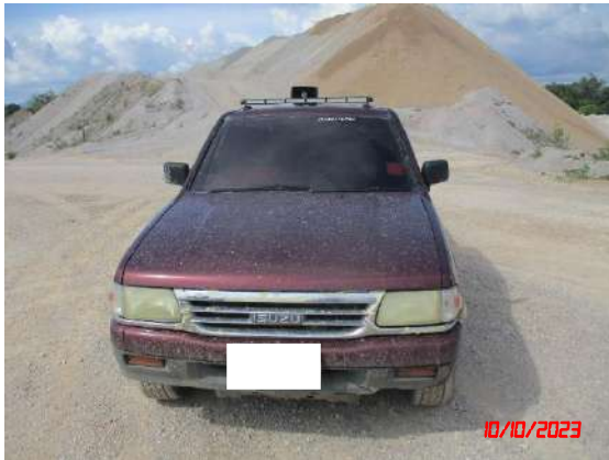
รูปที่ 26 รถติดตั้งสัญญาณเสียงเตือนก่อนการระเบิด
