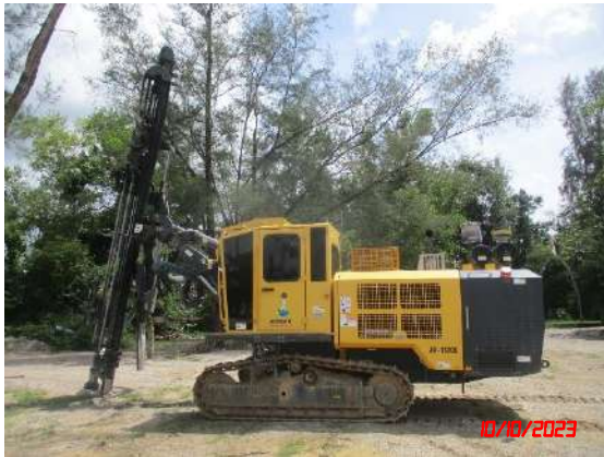
รูปที่ 27 เครื่องเจาะระเบิดที่ติดตั้งอุปกรณ์เก็บฝุ่นไว้บริเวณหัวเจาะ
