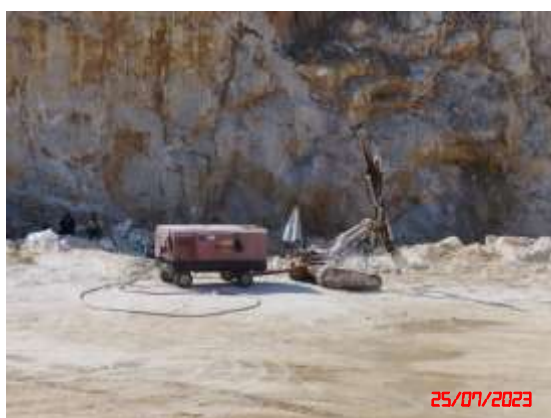
รูปที่ 14 เครื่องเจาะระเบิดที่ติดอุปกรณ์ถุงเก็บฝุ่นละออง
