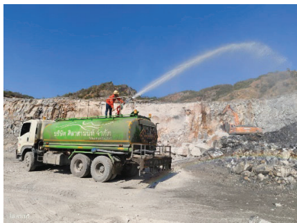
รูปที่ 2-30: การฉีดพรมน้ำกองแร่บริเวณ Mobile Crushing
