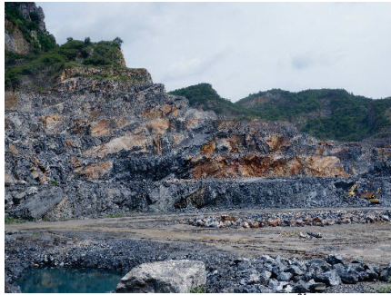
รูปที่ 2-1: การทำเหมืองแบบชันบันได
