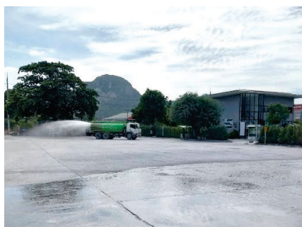
รูปที่ 2-7: การฉีดพรมน้ำบริเวณโรงโม่หิน
