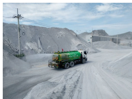
รูปที่ 2-8: การฉีดพรมน้ำบริเวณลานกองแร่
