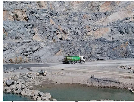
รูปที่ 2-10: การฉีดพรมน้ำบริเวณหน้าเหมือง
