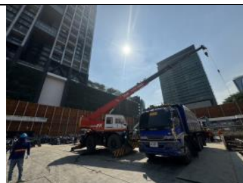
รูปที่ ผ8.57 รถเครนแบบโมบายเครน
