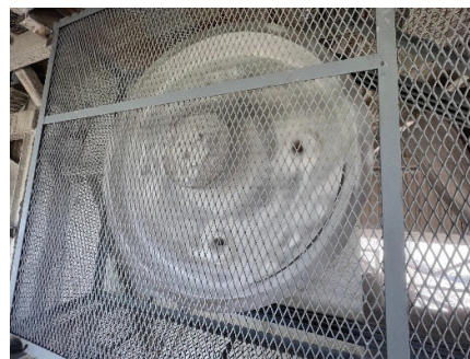
รูปที่ 2-42: การจัดส่วนปกปิดหรือแผ่นกัน (Guard) สำหรับเครื่องจักรกล
