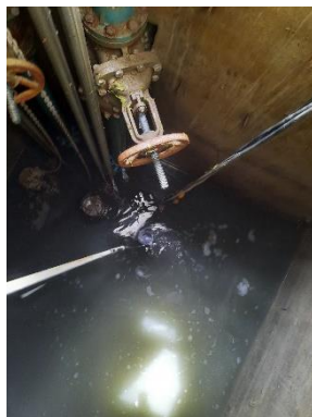
รูปที่ 3.31 ภาพแสดงการเก็บตัวอย่างน้ำจุดที่ 5 คุณภาพน้ำทั้งก่อนระบายออกนอกโครงการ บ่อตรวจสอบน้ำ/ตกขยะ
