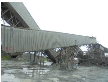
รูปที่ 2-19: การปิดคลุมโรงโม่หิน
