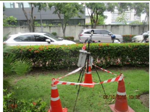
รูปที่ 3-8 การตรวจวัดระดับเสียง
