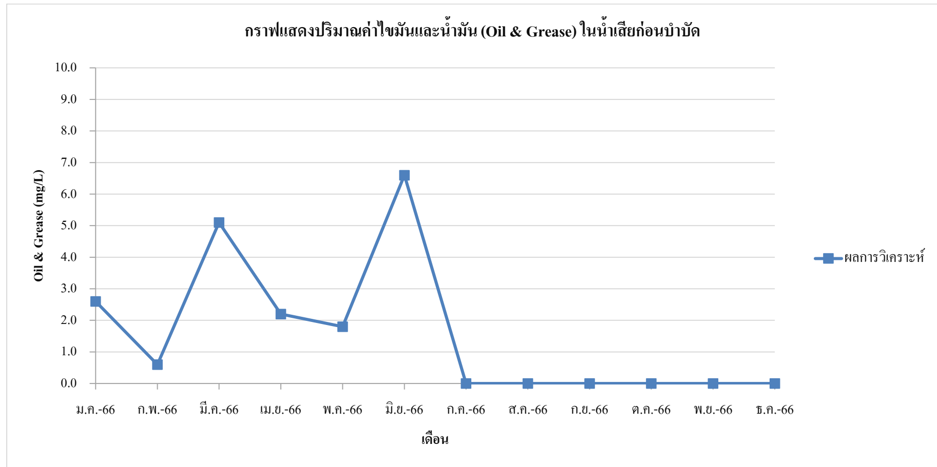
ภาพที่ 4-5 แสดงปริมาณค่าไขมันและน้ำมัน (Oil & Grease) ในน้ำเสียก่อนบำบัด
