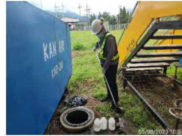
บ่อบำบัดน้ำหลังผ่านระบบบำบัดน้ำเสียสำเร็จรูปของอาคารผู้โดยสารขาเข้า
