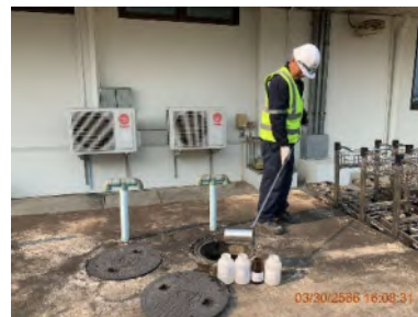
บ่อกักน้ำหลังผ่านระบบบำบัดน้ำเสียอาคารที่พักผู้โดยสาร
