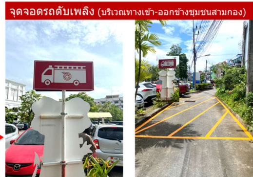
ภาพที่ 11-F ดำเนินการจัดทำช่องสำหรับจอดรถดับเพลิงในกรณีฉุกเฉิน ในบริเวณที่ใกล้กับจุดห้รับน้ำดับเพลิงตามที่กฎหมายกำหนด
