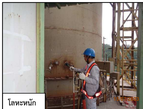
ภาพที่ 3.4 การตรวจวัดคุณภาพอากาศจากปล่องหม้อเผา 6
