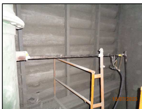
ภาพที่ 3.6 การตรวจวัดคุณภาพอากาศจาก ปล่องหม้อบดซีเมนต์ 6
