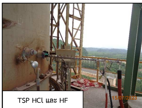
ภาพที่ 3.3 (ต่อ) การตรวจวัดคุณภาพอากาศจากปล่องหม้อเผา 5
