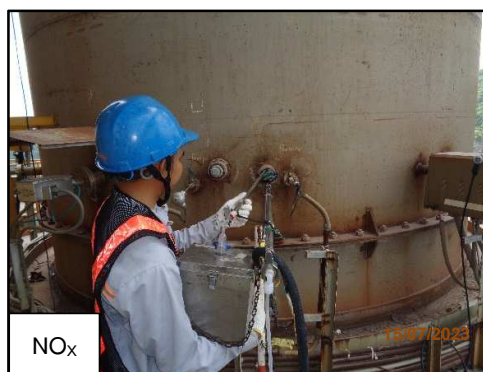
ภาพที่ 3.3 (ต่อ) การตรวจวัดคุณภาพอากาศจากปล่องหม้อเผา 5
