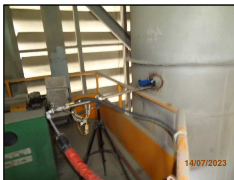
ภาพที่ 3.8 การตรวจวัดคุณภาพอากาศจาก ปล่องหม้อบดซีเมนต์ 9
