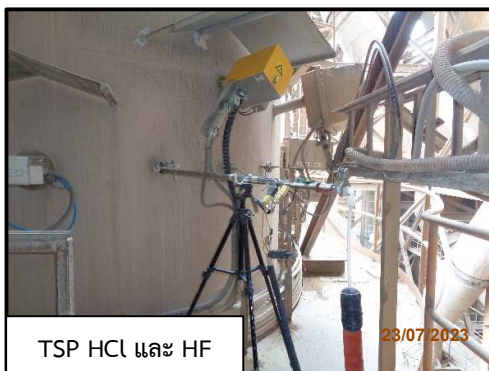
ภาพที่ 3.3 การตรวจวัดคุณภาพอากาศจากปล่องหม้อเผา 5
