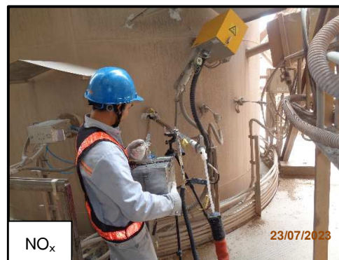
ภาพที่ 3.3 การตรวจวัดคุณภาพอากาศจากปล่องหม้อเผา 5
