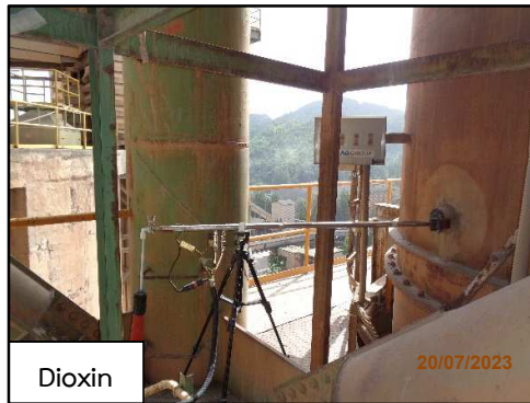
ภาพที่ 3.2 การตรวจวัดคุณภาพอากาศจากปล่องหม้อเผา 4
