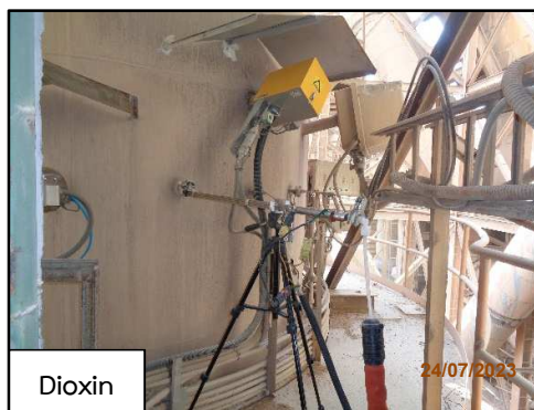
ภาพที่ 3.3 (ต่อ) การตรวจวัดคุณภาพอากาศจากปล่องหม้อเผา 5
