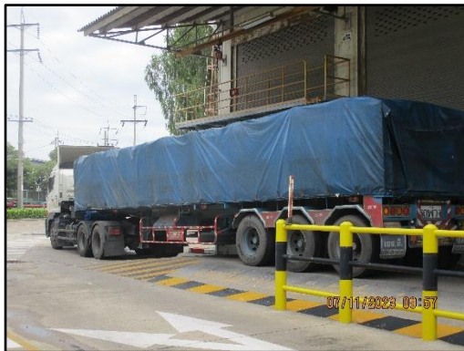
ภาพที่ 2.30 รถบรรทุกหินปูนที่มีการคลุมผ้าใบ และ ล้างทำความสะอาดล้อรถเพื่อป้องกัน การฟุ้งกระจายของเศษหินปูน
