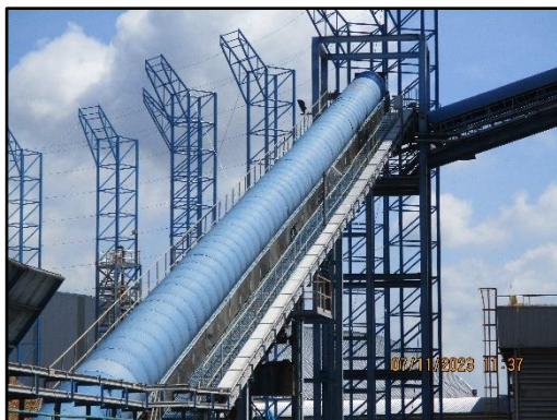
ภาพที่ 2.5 ระบบสายพานลำเลียงชิ้นไม้เข้าสู่ขั้นตอนการผลิตแบบปิด
