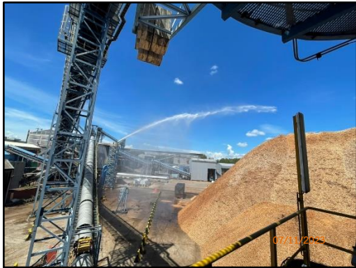
ภาพที่ 2.3 การฉีดพ่นน้ำบริเวณลานกองไม้ยูคาลิปตัส และบริเวณพื้นที่เตรียมชิ้นไม้สับ เพื่อป้องกันการฟุ้งกระจายของฝุ่น
