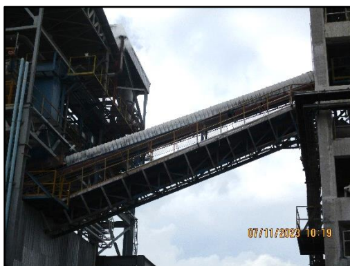
ภาพที่ 2.9 ระบบสายพานลำเลียง (Conveyer) ของโครงการหน่วยผลิตปูนขาว (Lime Kiln)
