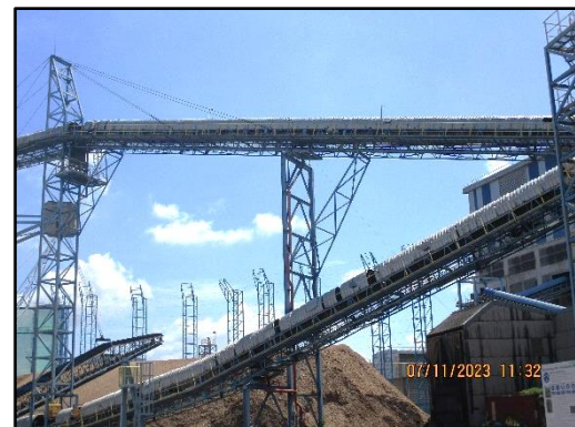
ภาพที่ 2.5 ระบบสายพานลำเลียงชิ้นไม้เข้าสู่ขั้นตอนการผลิตแบบปิด
