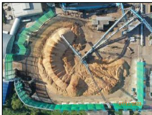
ภาพที่ 2.2 การติดตั้งตาข่ายและปลูกต้นไม้บริเวณลานกองขึ้นไม้สับ เพื่อป้องกันการฟุ้งกระจายของฝุ่น
