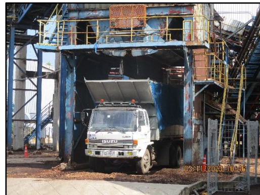
ภาพที่ 2.34 การบรรทุกเปลือกไม้ไปเป็นเชื้อเพลิงในหม้อต้มไอน้ำให้กำลัง (Power Boiler)
