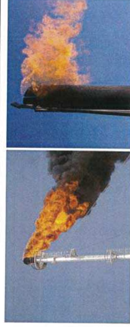
รูปที่ 4-10 ตัวอย่างการนี้เกิด Flame Pull-down
