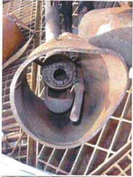
รูปที่ 2-17 ตัวอย่าง Pilot Burners
