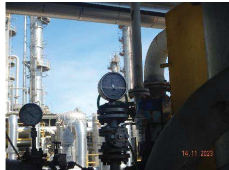
ภาพที่ 2.2-61 Pressure Indicator บริเวณกระบวนการผลิต
