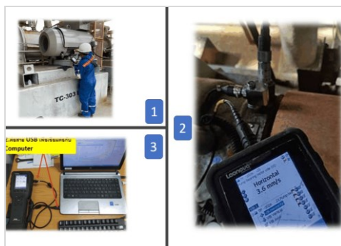
ภาพที่ 2.2-55 ระบบ Vibration Monitoring
