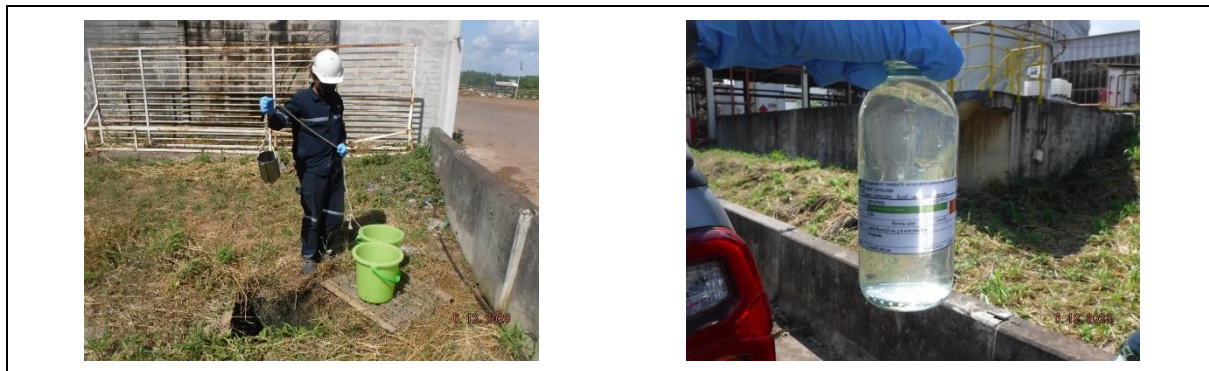
รูปที่ 3-12 แสดงการเก็บตัวอย่างคุณภาพน้ำทิ้งจากกระบวนการผลิต
