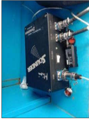
รูปที่ 4 เครื่อง ECHO SOUNDER “KNUDSEN CHRP3212”
