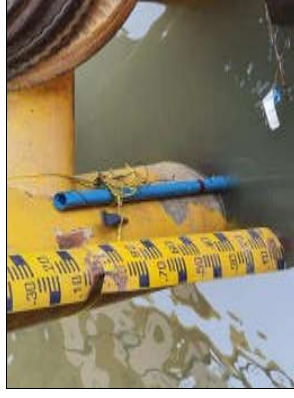
รูปที่ 10 การติดตั้งเครื่องวัดระดับน้ำ
