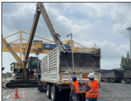
รูปที่ 2-24 การขนถ่ายสินค้าด้วย Mobile Grab
