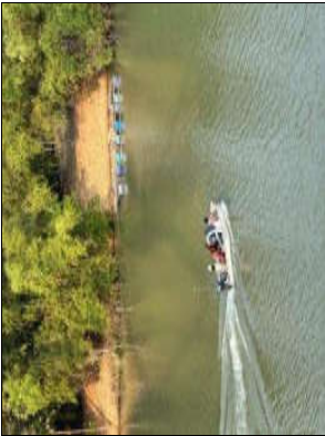
รูปที่ 15 สำรวจระดับพื้นที่หนองน้ำ และการบันทึกข้อมูลด้วยโปรแกรม HYPACK
