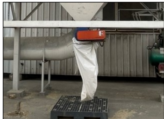
รูปที่ 2-14 อุปกรณ์ดักจับฝุ่น (Bag Filter)
