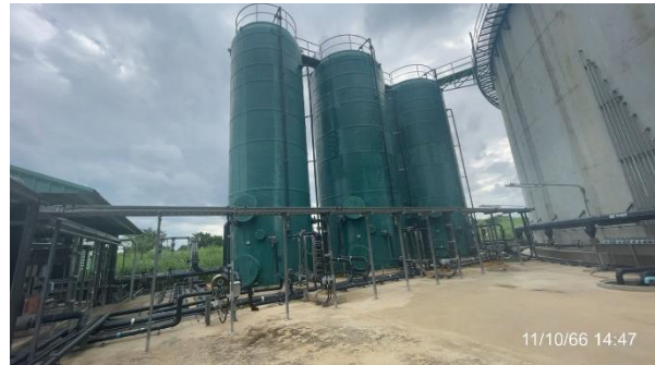
รูปที่ 2 ระบบรวบรวมและกำจัดก๊าซ H 2 S
