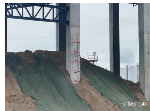
รูปที่ 6 เสาบอกระยะความสูงกองกากอ้อย
