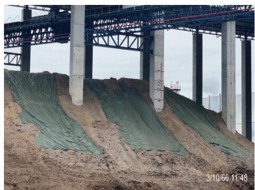
รูปที่ 6 เสาบอกระยะความสูงกองกากอ้อย
