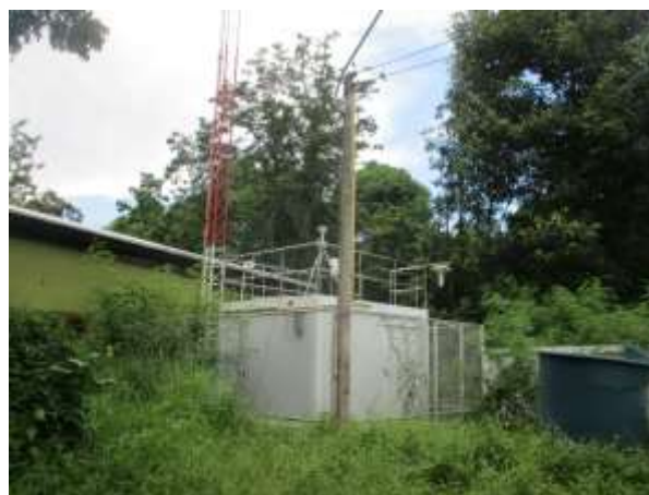
รูปที่ 5 สถานีตรวจวัดคุณภาพอากาศแบบต่อเนื่อง บริเวณโรงเรียนวัดแหลมฉบัง
