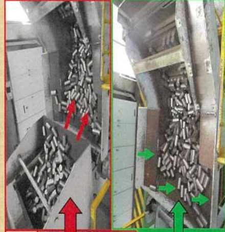
เครื่องลำเสียงท่อนเหล็ก : ขณะท่อนเหล็กเข้าเครื่องจะเกิดเสียงดัง
