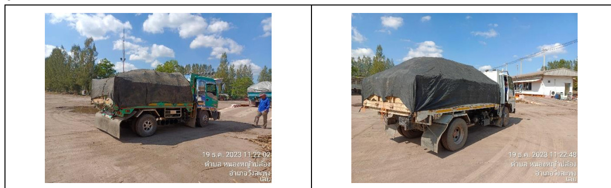
รูปที่ 20 การปิดคลุมท้ายรถบรรทุกกากตะกอนหม้อกรองด้วยผ้าใบ
