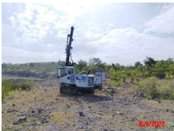
รูปที่ 15 เครื่องเจาะระเบิดและเครื่องทุบย่อยหินใหญ่
