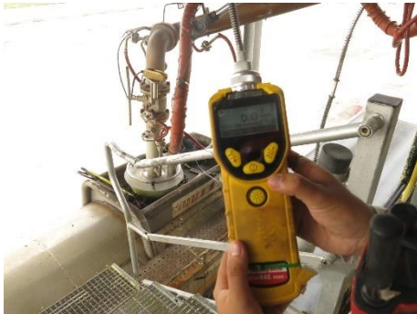
ภาพที่ 2.2-2 (14) การตรวจวัดสารอินทรีย์ระเหย ขณะการสูบลำอากาศอินทรีย์ด้วยเครื่องวัดแบบพกพา
