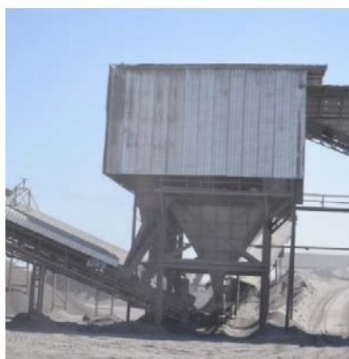
รูปที่ 2.1-29 ระบบไซโคลนดักฝุ่น
