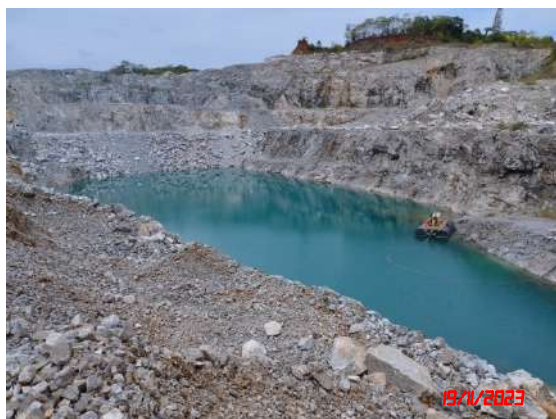
ป่อรับน้ำจากขุมเหมือง (Sump)
