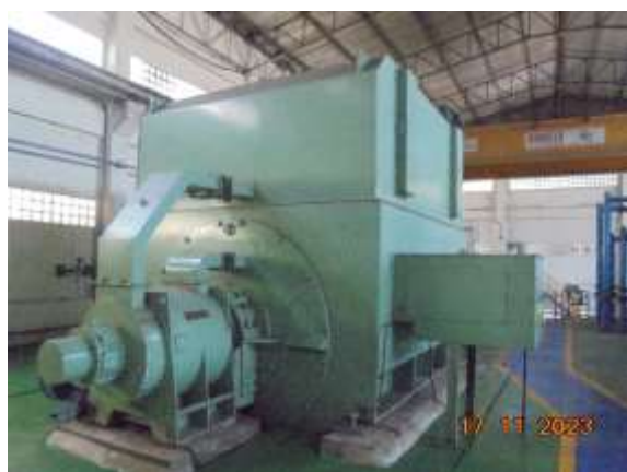
รูปที่ 19 การปิดครอบเครื่องจักรอุปกรณ์ที่มีเสียงดัง
