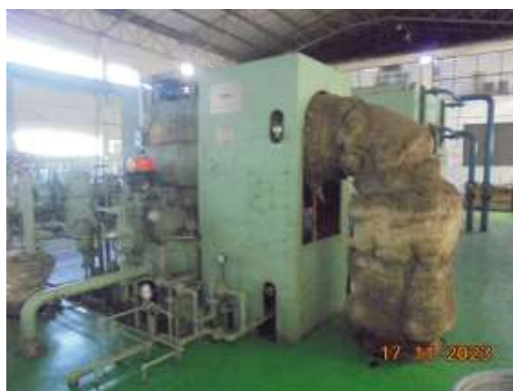
รูปที่ 19 การปิดครอบเครื่องจักรอุปกรณ์ที่มีเสียงดัง
