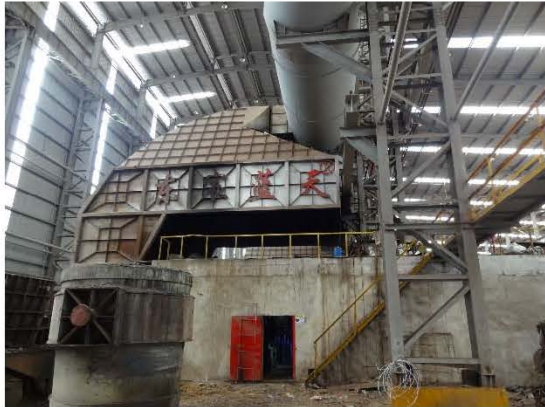
ภาพที่ 3.1 ระบบรวบรวมฝุ่น (Hood)
