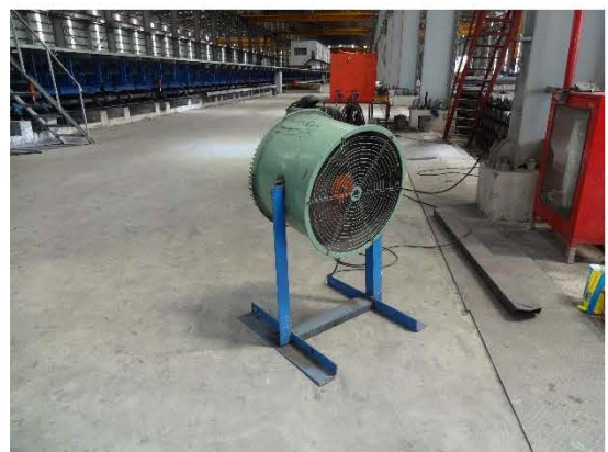
ภาพที่ 3.35 พัดลมระบายอากาศ
