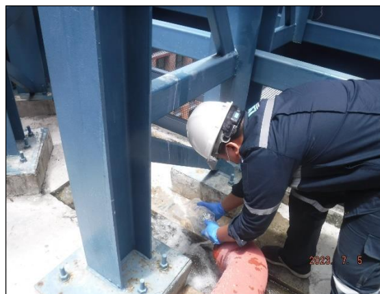
การเก็บตัวอย่างน้ำจากท่อน้ำทิ้งจากหอผึ่งเย็น (Cooling Tower)
